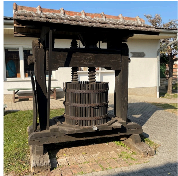
Abbildung 13: Diese Weinpresse ist eine Spindelpresse mit zwei durchgehenden Spindeln. Diese können durch archimedische Spiralen beschrieben werden. Der Korb stellt einen Zylinder dar.
