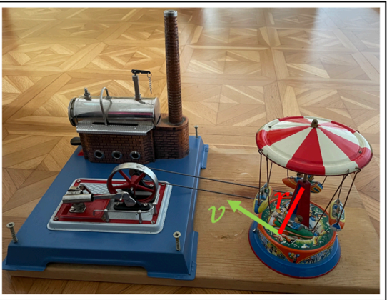
Abbildung 10: Die Dampfmaschine treibt ein Karussell an. Die Bestimmung des Radius r (rot) schult den Umgang mit Lineal/Geodreieck und die Berechnung der Bahngeschwindigkeit (grün) führt in das Lösen von Gleichungen ein.
