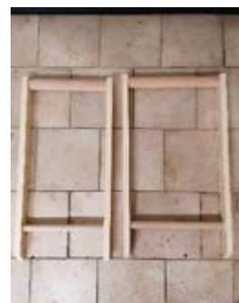
9) Runde mit der Raspel die Ecken ab, sodass sie an das Rundholz angeglichen sind. Schleife alle scharfen Kanten mit dem Schleifpapier ab. Achte auf die Schleifrichtung!
